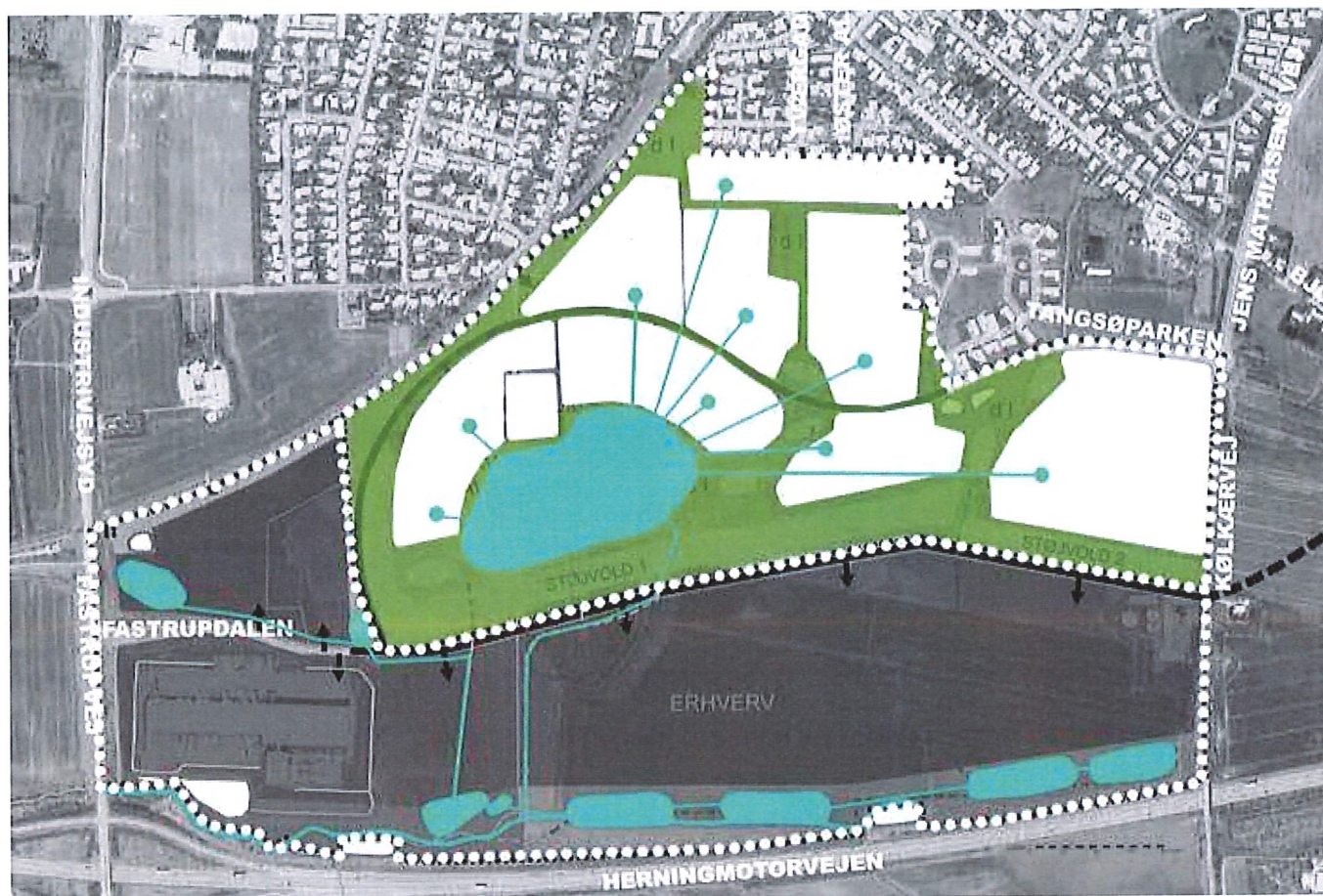
Princip for afvandingsplan. Overfladevand i erhvervsområdet håndteres i regnvandsbassiner og klimaarealer i den sydlige del af erhvervsområdet. Der vil være afløb/overløb fra søen nord for erhvervsområdet til recipienten i den sydlige del af erhvervsområdet
